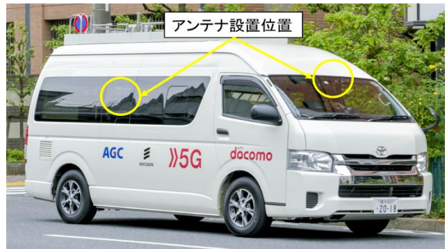
図4 5G ガラスアンテナ設置位置
